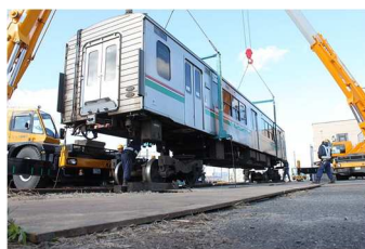
▲大型クレーン 2 台で吊り上げ ▲慎重に台車の上へ
