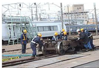
▲台車を線路上へ移動 ▲作業位置へ移動
