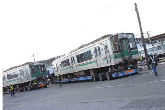
▲分解されて運ばれた台車 ▲搬入された 701 系車両
