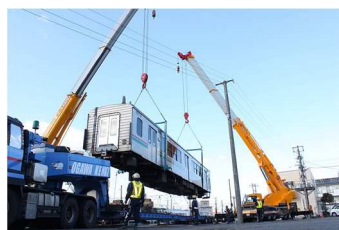
▲大型クレーン 2 台で吊り上げ ▲慎重に台車の上へ
