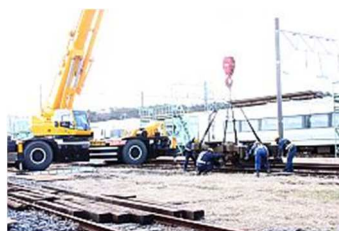
▲台車を線路上へ移動 ▲作業位置へ移動
